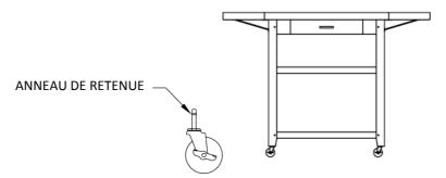
NOTE: SI LES ROULETTES SONT DIFFICILES À INSÉRER DANS LA PATTE, ÉCRASER LÉGÈREMENT L'ANNEAU DE RETENUE SUR LA TIGE DE ROULETTE AVEC UNE PINCE À LONG NEZ ET ESSAYEZ DE RÉ-INSÉRER LA ROULETTE
